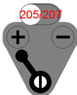
Рисунок 29 – Отсутствие контроля положения на спаренной стрелке
